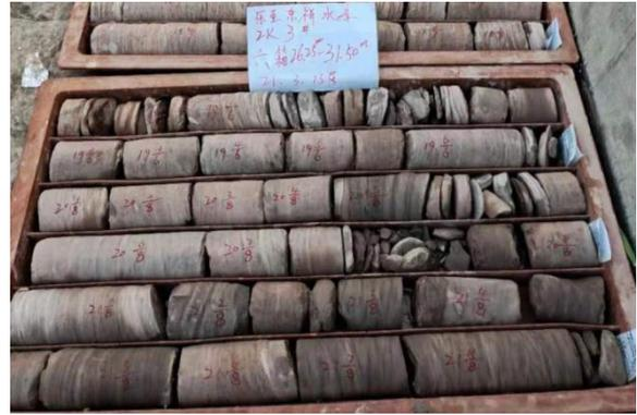
照片 3.1-6 钻孔揭露坝基岩体层理发育
