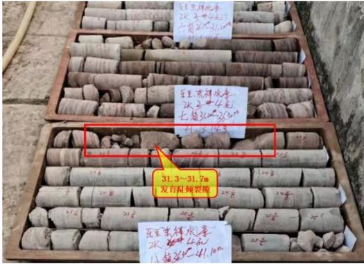
照片 3.1-5 钻孔 ZK4 揭露陡倾裂隙
