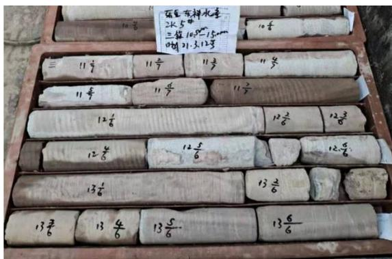
照片 3.1-3 钻孔揭露条石砌体情况
