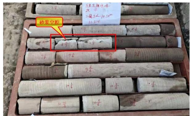
照片 3.1-4 钻孔 ZK4 揭露一条砂浆空腔
